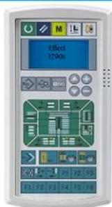
**Pannello LCD a bordo macchina per la selezione e regolazione cucitura dell'asola**
